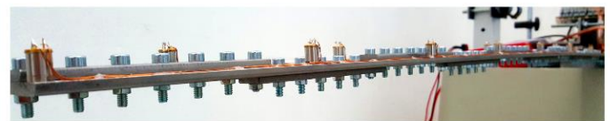
Abbildung 4 Balkenstruktur mit reversiblen Schäden
