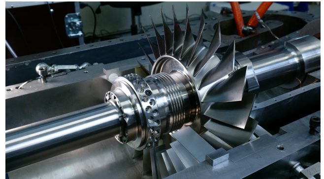
Verdichterblick des einstufigen Verdichters
